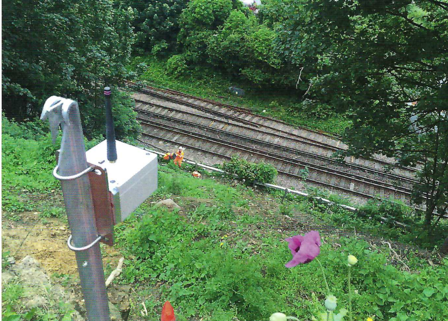
Bild 8: Hangüberwachung mittels an Erdspeissen montierten drahtlosen Neigungssensoren
