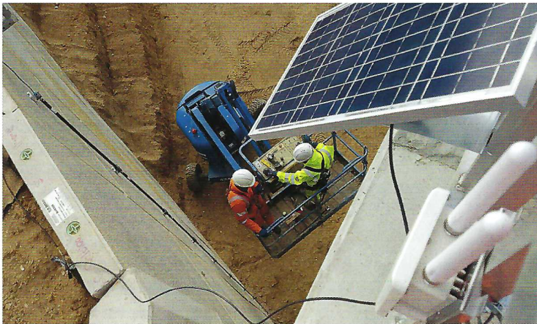
Bild 11: MEMS-Neigungssensoren, implementiert in Carbonfaser-Stäbe, hier als Kette montiert zur Bestimmung von Bauwerksdeformationen
